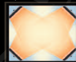
СХЕМА УСТАНОВКИ ОБОГРЕВАТЕЛЕЙ HELIOSA® HI DESIGN (рис.3)
